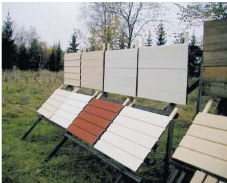
Fältförsök med brandskyddad träpanel för bruksklass U.
